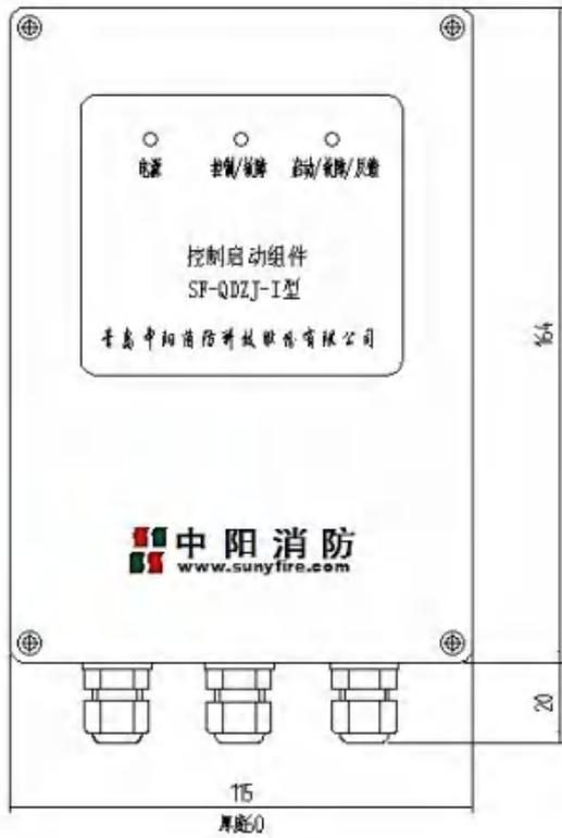
图 2 控制启动组件外形
